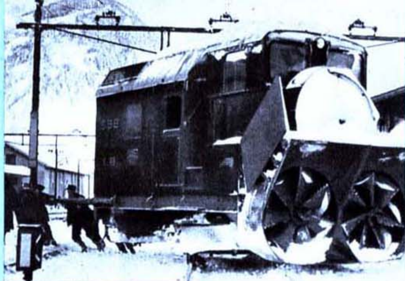
CHEMINOTS FAISANT PIVOTER LE CHASSE-NEIGE SUR LUI-MÊME
