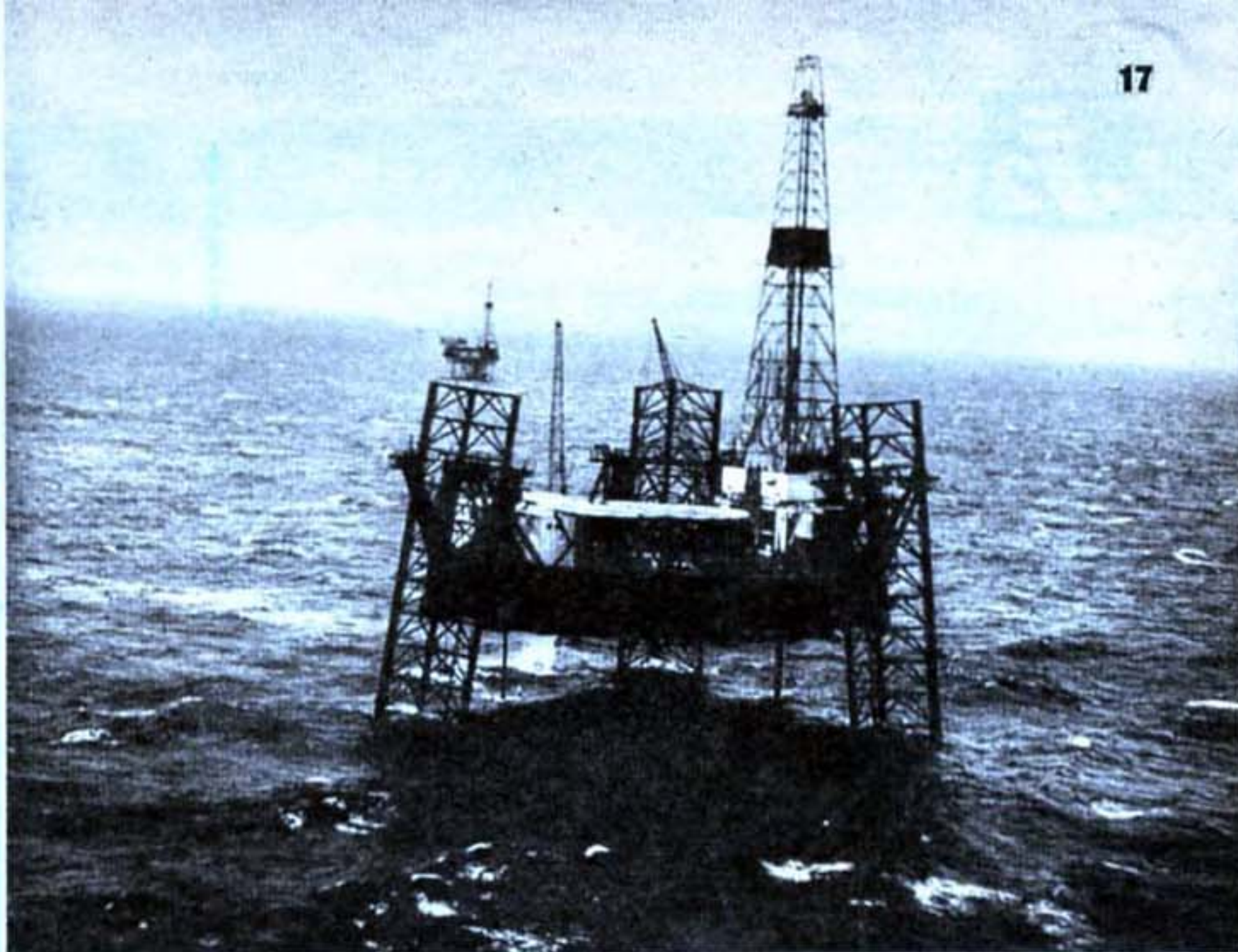
La plate-forme en position de travail : elle ne flotte pas sur les eaux, mais est supportée par les trois pilotis métalliques.
