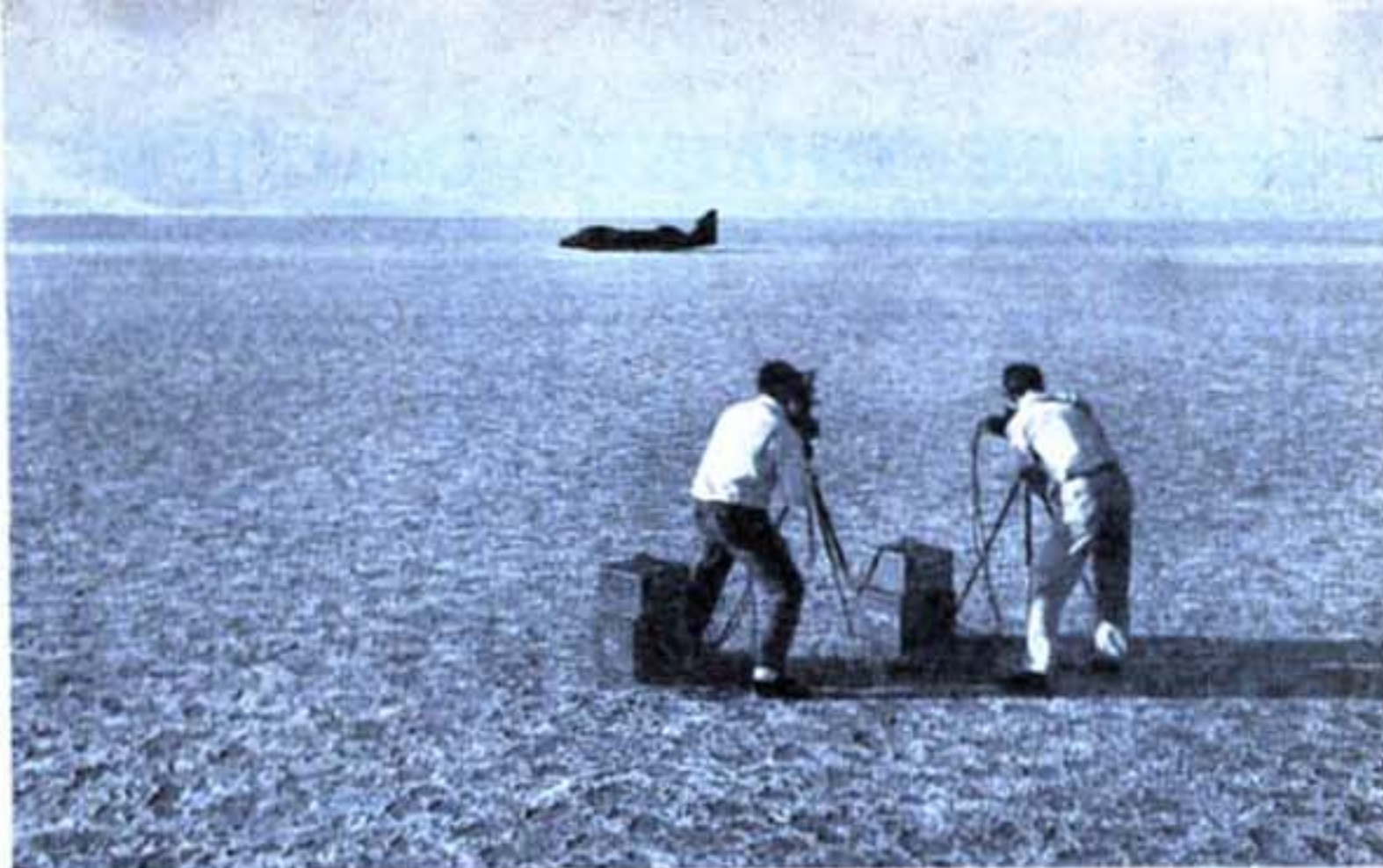
Chronométrage au cours d'un essai sur le lac Eyre, en Australie. Le matériel utilisé est constitué de deux caméras Longines avec leurs horloges à quartz.
