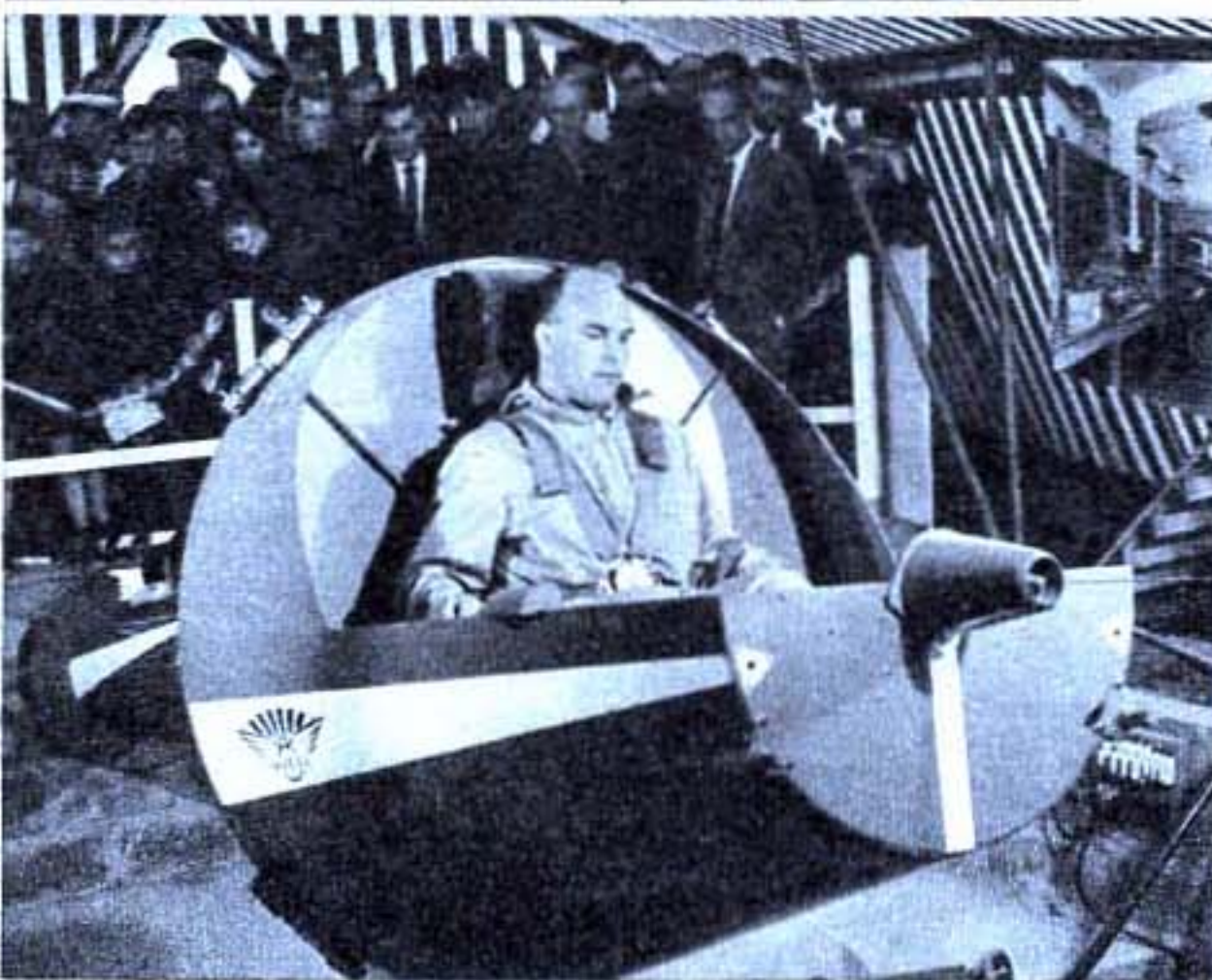
Simulateur de vol spatial. Cet appareil dirigé par des jets d'azote permet de recréer les manœuvres de rentrée dans l'atmosphère d'une capsule satellisée.
