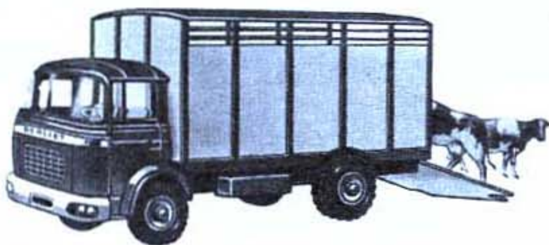
... la Bétaillère GAK Berliet : porte arrière formant plan incliné. 2 vaches - réf. 577.
