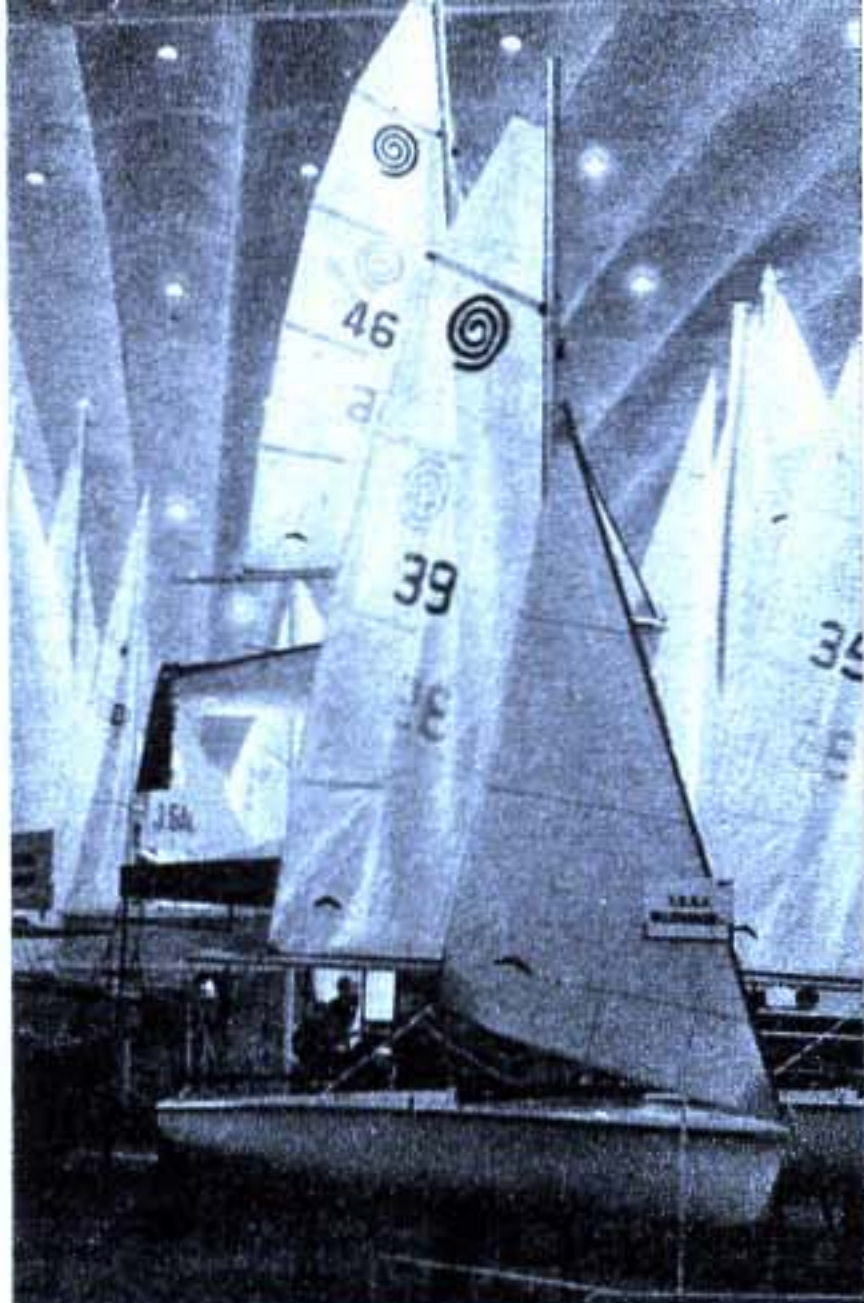
LE TIKI : dériveur d'initiation de bonne stabilité. L'ouverture du puits de dérive permet l'orientation de la dérive par le jeu d'un sandow. Longueur 3,95 m, largeur 1,45 m. Coque polyester.
