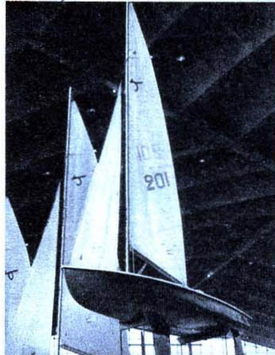
LE CAPRICORNE : une production des Etablissements Matra-Sports. Grâce à son arrière ouvert, il permet une vidange instantanée de l'eau embarquée. Longueur 4,01 m. Coque stratifiée en tissu de verre polyester.
