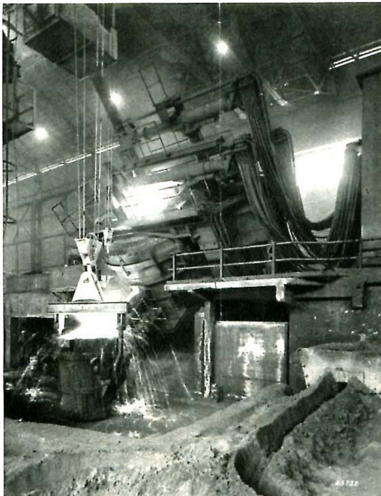
Cette photo vous montre le four ouvert. Son couvercle pivote pour en permettre le remplissage.
