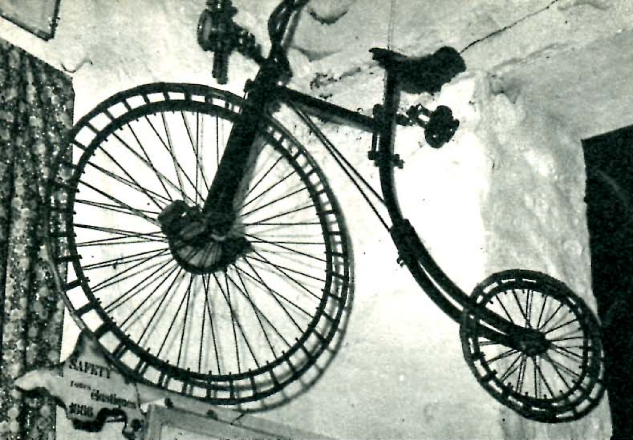
Un « Safety » de 1886. Pour remplacer les pneus, une jante articulée montée sur un grand nombre de petits ressorts.
