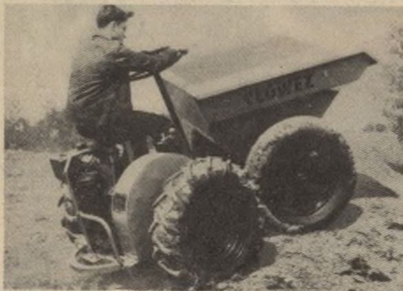
Dumper : transporte 1 tonne de terre, béton, ciment, sable en tous terrains. C'est une vraie brouette à moteur.
