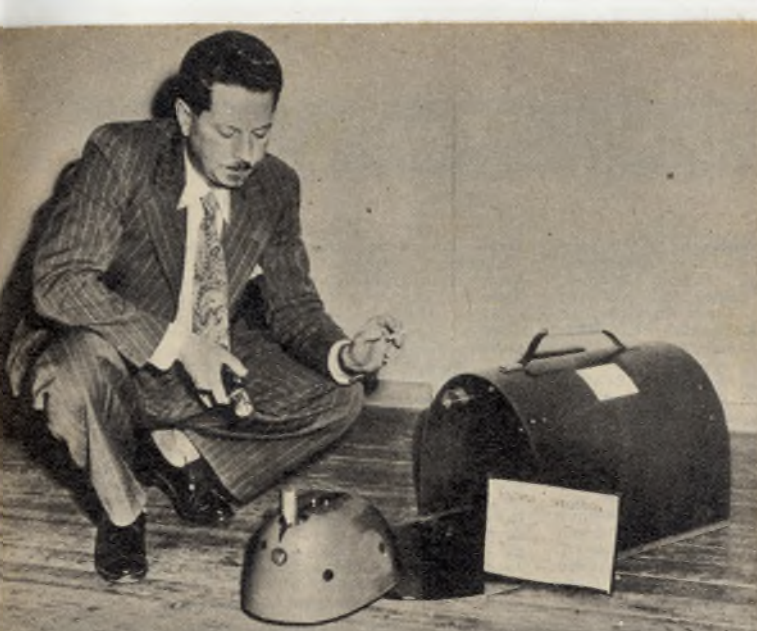
La « tortue électronique » de Grey Walter se comporte comme une véritable tortue. Elle marque les débuts d'une science nouvelle : la cybernétique.
