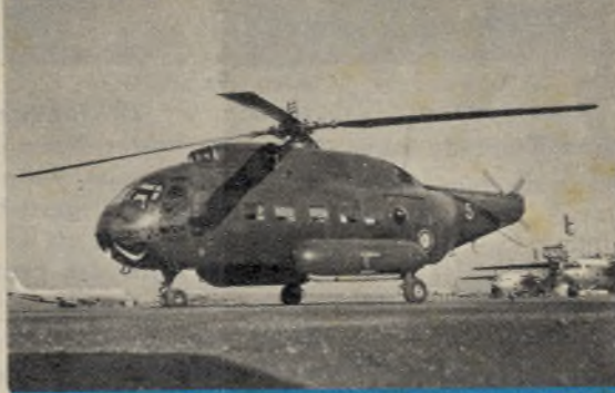
Le Frelon (français), hélicoptère construit par Sud-Aviation, peut transporter vingt à trente passagers.
